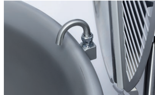
Påfyllningskran för vatten på pannans kant.
